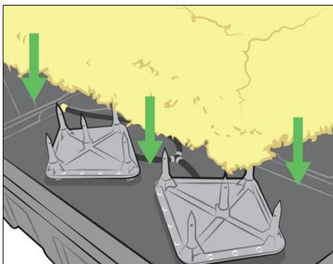
Mette le ballot ou le foin en vrac sur les rampes / pointes de vapeur et tasser normalement le foin. Abaisser le couvercle et fermer les crochets
