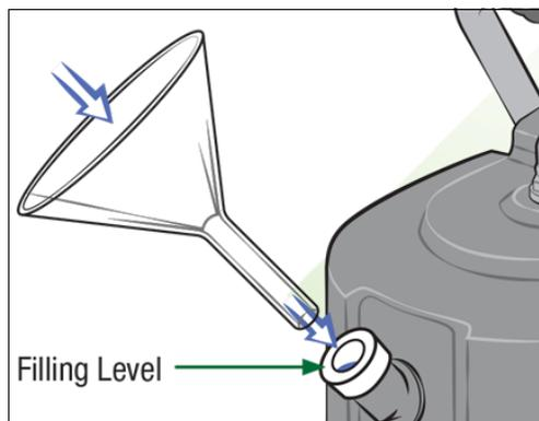
Remplissez le générateur de vapeur 3.5l pour le One et jusqu'à 8l pour le 600 et le 2000
